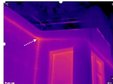
T-53: ( $\Delta P+$ ) Exfiltration d'air mineure à la jonction de l'enveloppe verticale et la toiture
