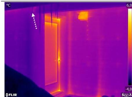
T-11: ( $\Delta P+$ ) Exfiltration d'air mineure à la jonction poutre/mur (voir aussi thermogrammes intérieurs T-63).
