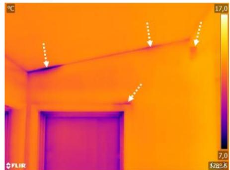
T-75: ( $\Delta P$ -) Mouvements d'air à la jonction de l'enveloppe verticale et de la toiture, au niveau de la poutre d'acier et par le cadrage
